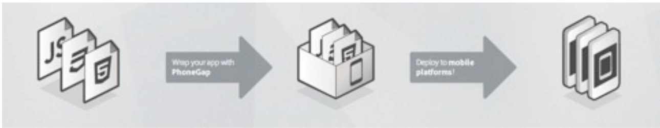
Figure 17: Schéma représentant le fonctionnement de PhoneGap
